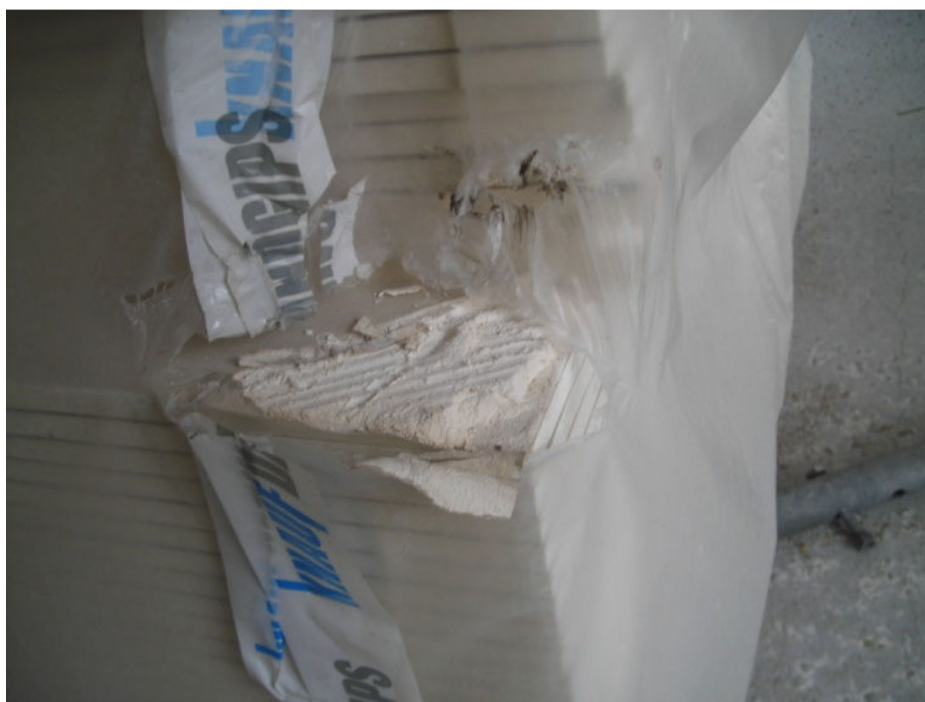
Bild 5.15 Skadat gips på Gyllenstjärna.
