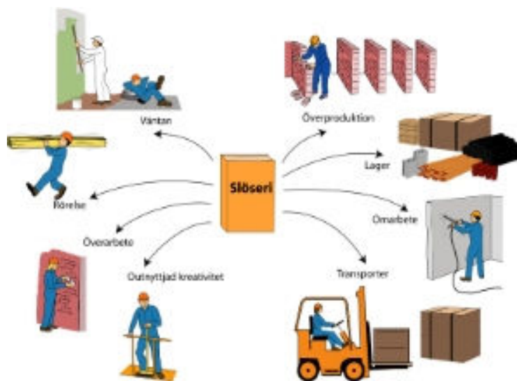
Figur 3.4 Exempel på var slöseri finns i byggprocessen. 83
