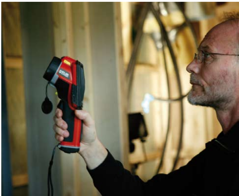
Mätning av läckage med värmekamera. Foto: Michael Malmberg/TellUs Stories AB
